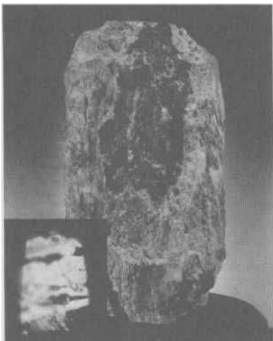
Кусок урановой руды. Черные участки — урановая смолка (оксид урана); в нижнем левом углу фотография, на которой зафиксировано радиационное излучение образца
